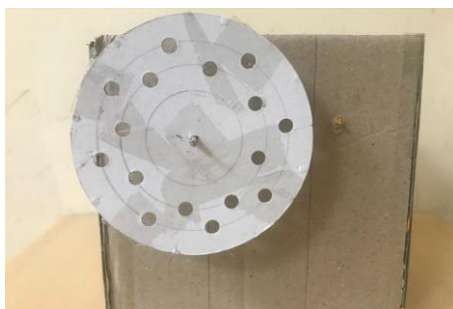
圖三：變速機構及測音頻片示意圖
