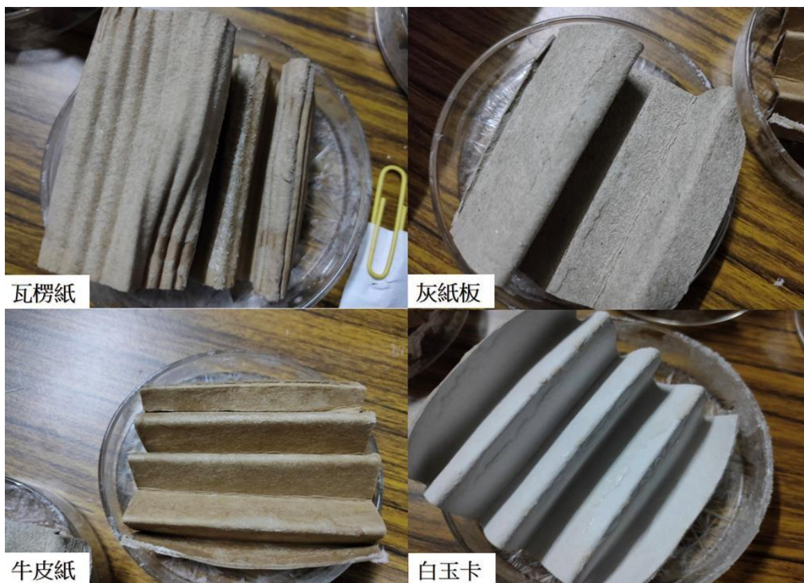
圖(三)尿素在不同紙質(觀察面)上的生長情形
