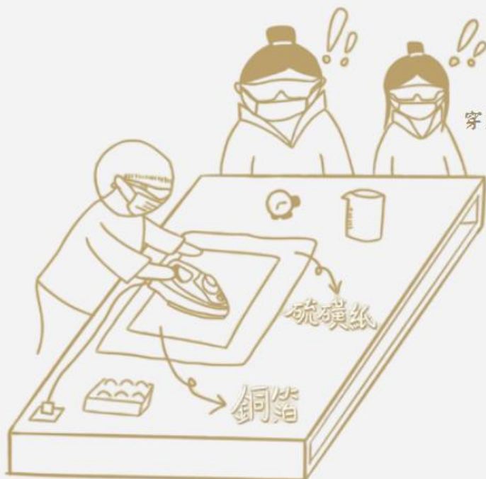
在銅箔上覆蓋硫磺布 使用電熨斗加熱
