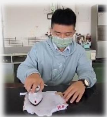
在銅箔上覆蓋硫磺布 使用電熨斗加熱
