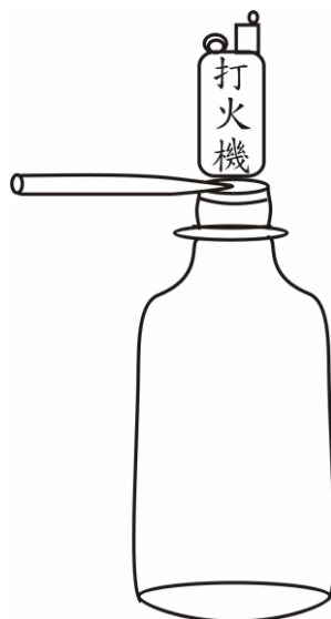
圖二、用打火機壓扁(封住)管口
