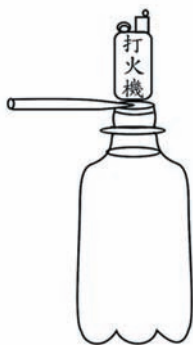
圖二：打火機壓扁(封住)管口
