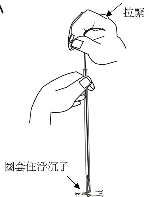
圖四、手指抓住吸管的頂端，另一手的手指拉緊塑膠繩以束緊浮沉子
