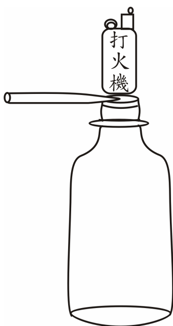
圖二、用打火機壓扁(封住)管口
